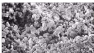
Рис 2. Структура анодной пластины нового NiCd аккумулятора
