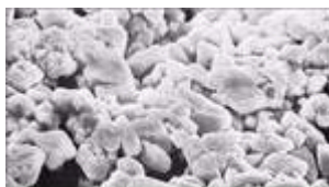
Рис 4. Структура анодной пластины восстановленного NiCd аккумулятора
